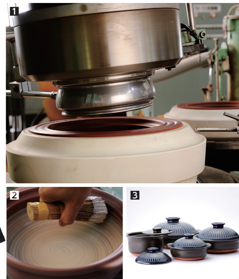
1 2 成形と施釉は機械と人の手の両輪で行っており、それぞれの製品に適したさまざまな方法がとられている 3 伝統的な焼き物「四日市萬古焼」の土鍋
