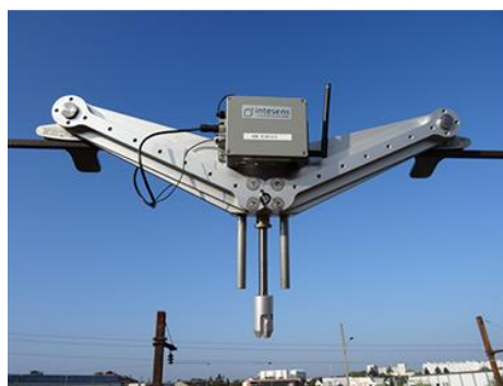
図 11: Intesens の開発した架線の張力測定センサー
