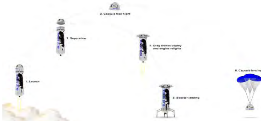
図表 13:「ニューシェパード」ロケットの垂直着陸の仕組み
