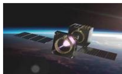
MomentumのVigoride。Vigoride Extendedは一部のVS-GEOをLEOからGTOに移動することが可能。
