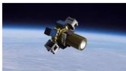
SpaceflightのSherpa FX。Sherpa LTEモデルは一部のVS-GEO衛星をGTOに投入できる。
