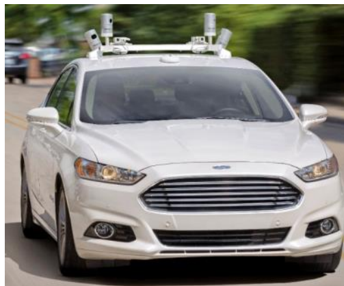
図表 11: Ford 社が開発を進める「Ford Fusion Hybrid」ベースの自動運転車
