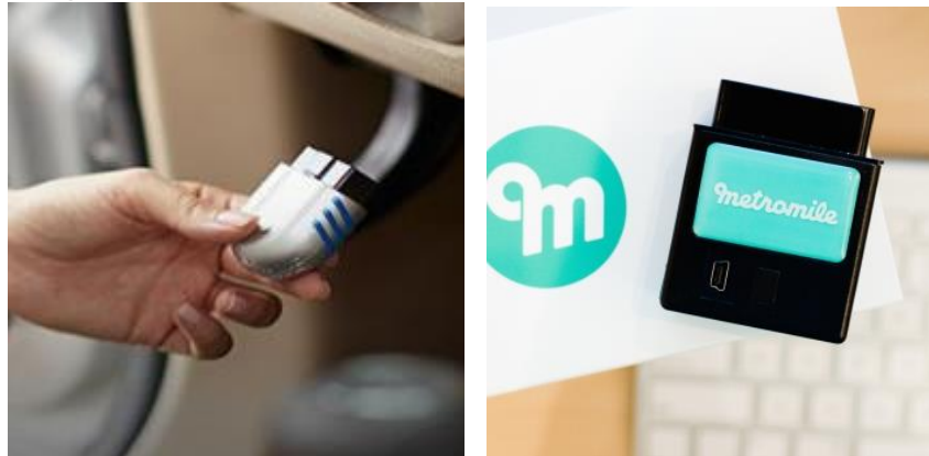
図表 6: Progressive 社(左)と Metromile 社(右)の自動車保険に関する IoT デバイス
