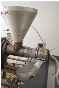
⑤ (オイル用) 機械に入れて油を絞る。搾り取った固体はプロテインの塊のため、パウダー化して販売。
