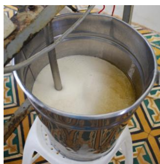
⑤ (オイル用) 機械に入れて油を絞る。搾り取った固体はプロテインの塊のため、パウダー化して販売。
