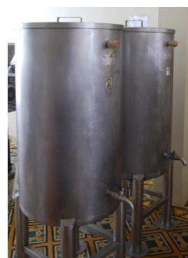
⑤ (オイル用) 機械に入れて油を絞る。搾り取った固体はプロテインの塊のため、パウダー化して販売。
