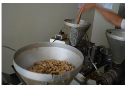
⑤ (オイル用) 機械に入れて油を絞る。搾り取った固体はプロテインの塊のため、パウダー化して販売。
