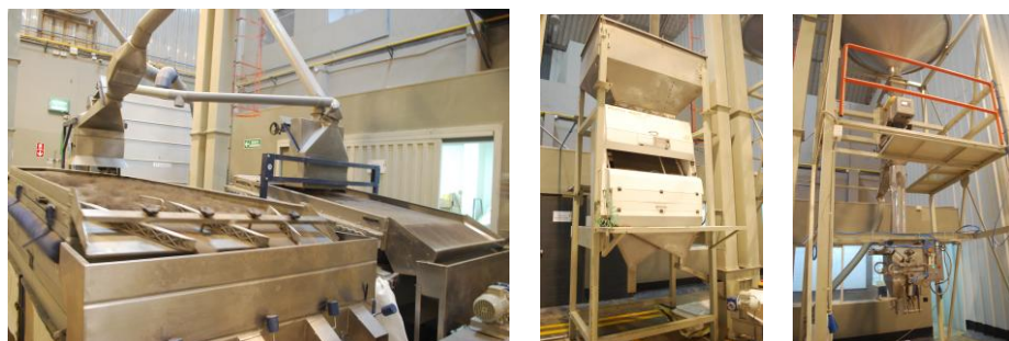
チアシードに使用している比重選別機、色選別機（スキャナー）、袋詰め機械
