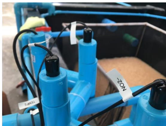
写真 2-6 センサープローブを水位可動式フローターに設置した様子
