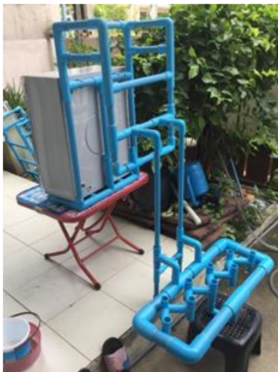
写真 2-8 水位可動式フローターの外観
