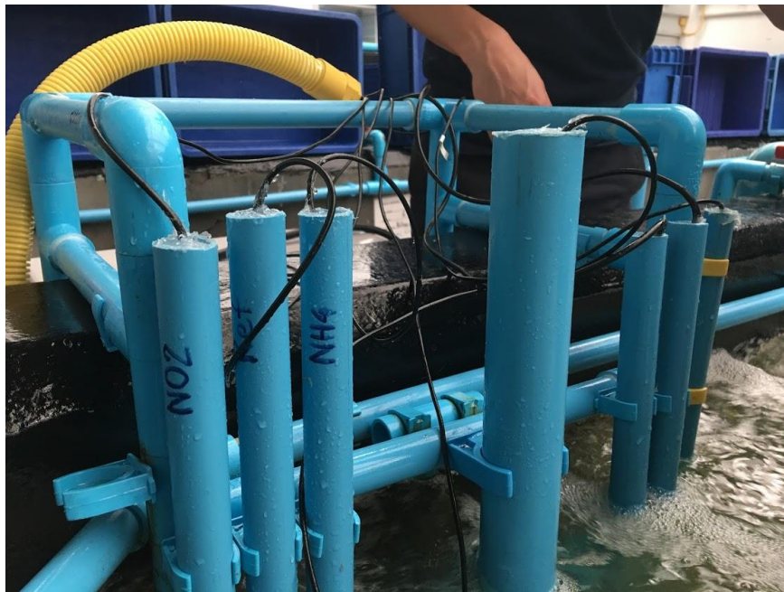
写真 2-17 シリコン付きセンサーパイプの設置風景
