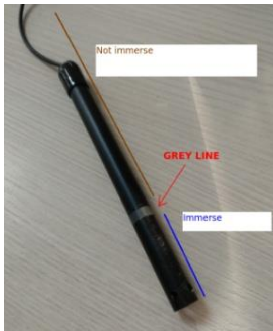
写真 2-11 センサープローブにおける防水境界線
