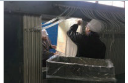
圧搾機から酒粕を剥がしている様子。
