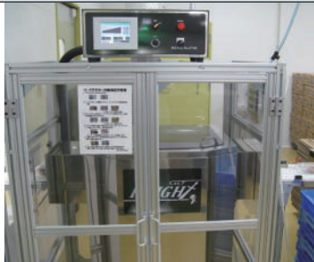
⑩ピンホール検査機
