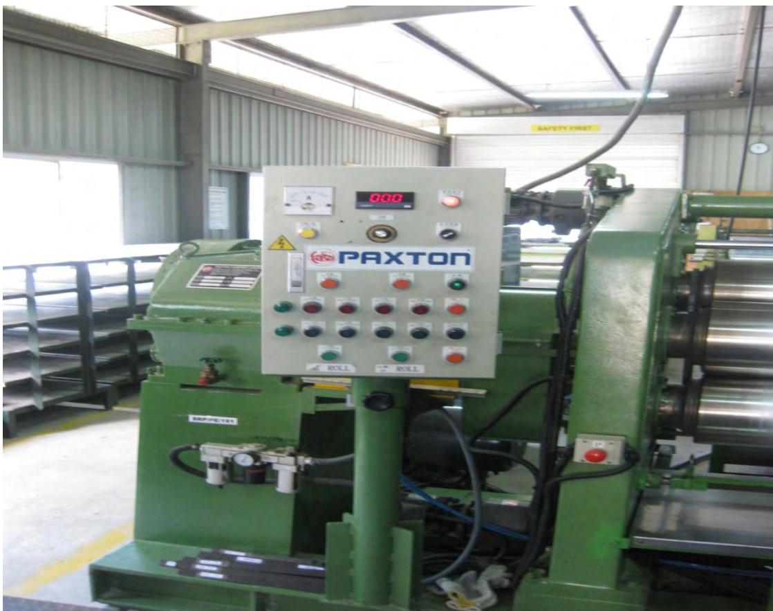
コンパウンド状態の材料を延ばす機械(台湾製)
