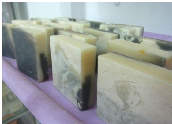
熟成期間中の石けん。オイルとアルカリ(苛性ソーダ)を混ぜた後、5~6週間寝かせて熟成させる。
