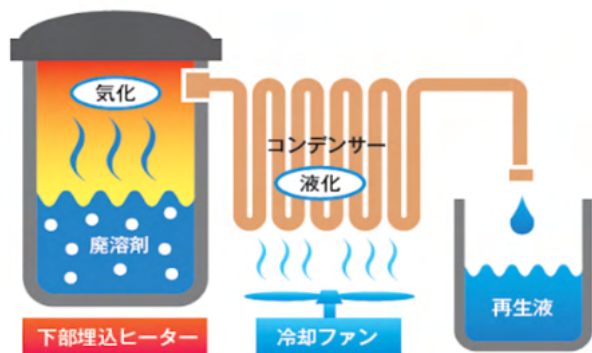
溶剤再生装置の仕組み
