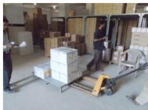
荷捌き用のハンドリフト
