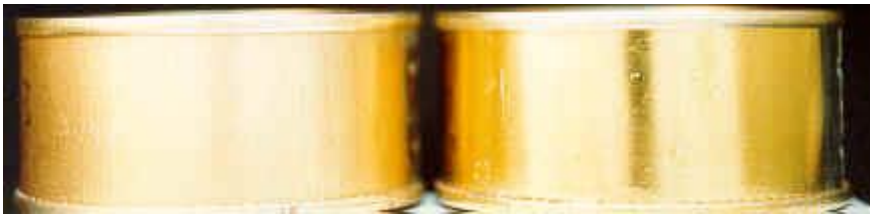
外側にある内側コーティング-スリーピース缶の外側コーティング
