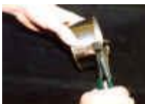
図 4.1.3.c-ダブルシームの切断
