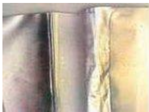
許容可能なシールの典型的な破損（融合なし）
