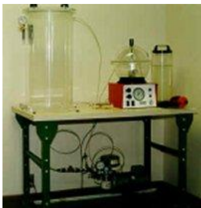
図 4.10 中立浮力の圧力を決定するための試験装置
